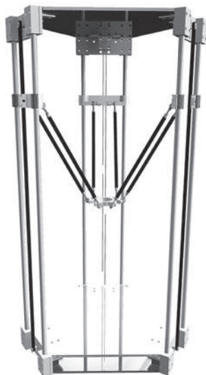
Figura 1. Concepto 1, mecanismo con actuadores lineales.
