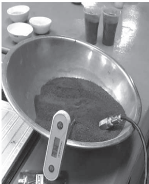
Figura 8. Medición de temperatura con sensor SHT10
