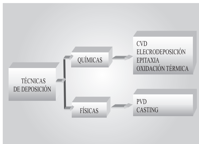
Figura 7. Técnicas de construcción de Nanomateriales
