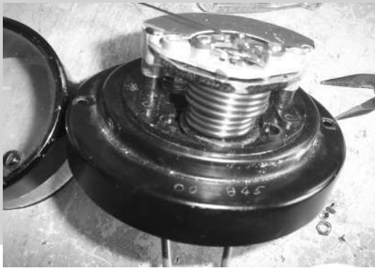
Figura. 7 Vista inferior del instrumento de hierro móvil
